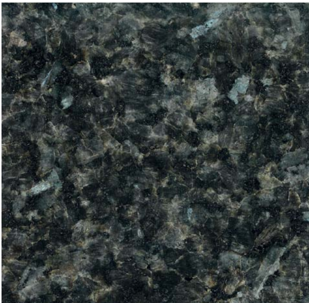
AFBEELDING 22. | Gepolijste larvikiet Emerald Blue Pearl van Krukåsen. Bron: Monster van Lundhs, 15 x 15 cm, gescand, collectie R. Egberink.
